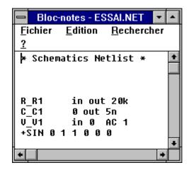
Lors du lancement de la simulation, l'éditeur de schéma génère le fichier de commande du simulateur (extension .cir par défaut). Ce fichier se présente également sous forme ASCII et peut, en cas de problème, être modifié en entrant à la main les différentes commandes *PSpice*. Un exemple de fichier de commande est illustré ci-dessous :
