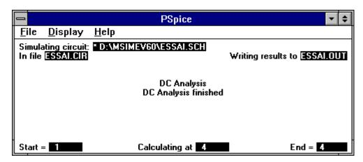
Lorsque la simulation est terminée, le programme lance automatiquement l'affichage. Le lancement automatique de *PROBE* peut être désactivé à l'aide du menu **Analysis** -> **Probe Setup...**
